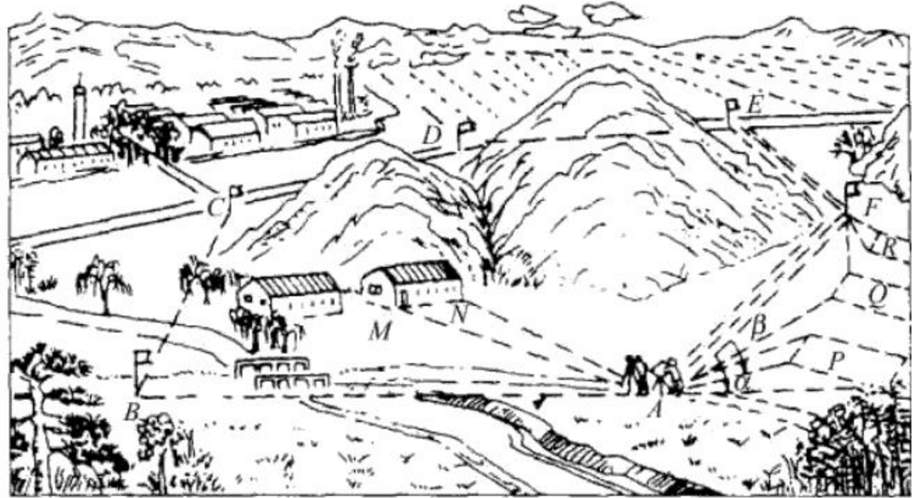
图 1-1 控制测量与碎部测量示意图
